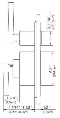
M1-4303 LEVER PRESSURE BALANCE WITH LEVER 2-WAY DIVERTER TRIM ONLY, TO SUIT M1-4101 ROUGH
